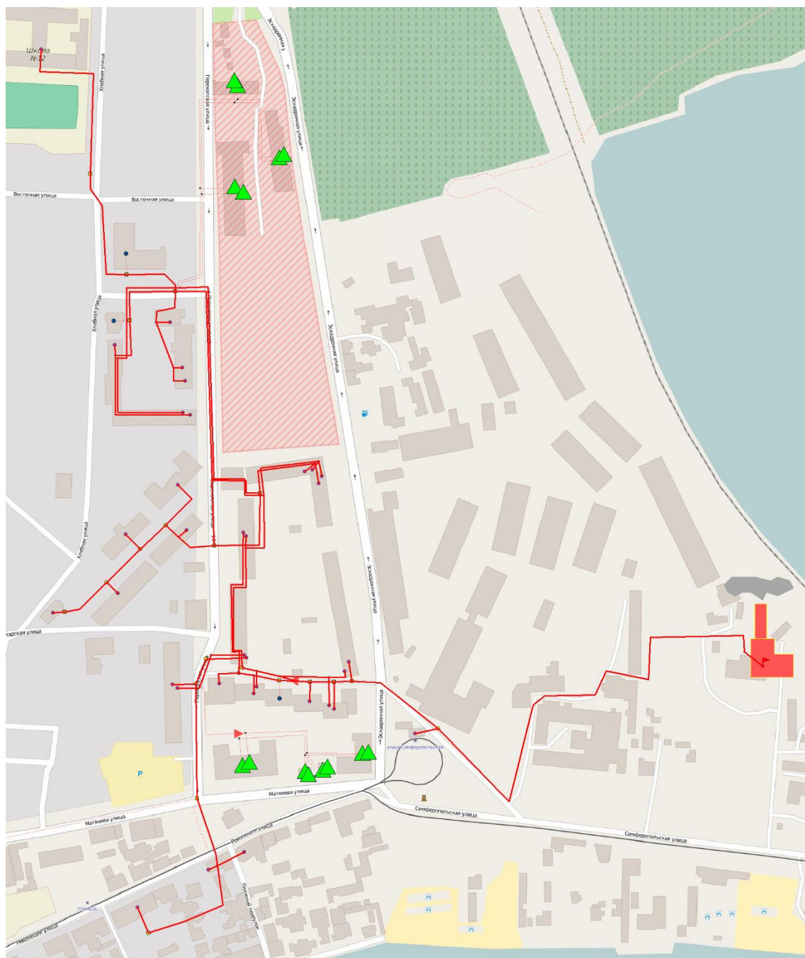
Рисунок 14 – Схема и структура тепломагистралей котельной по ул. Симферопольская, 98
