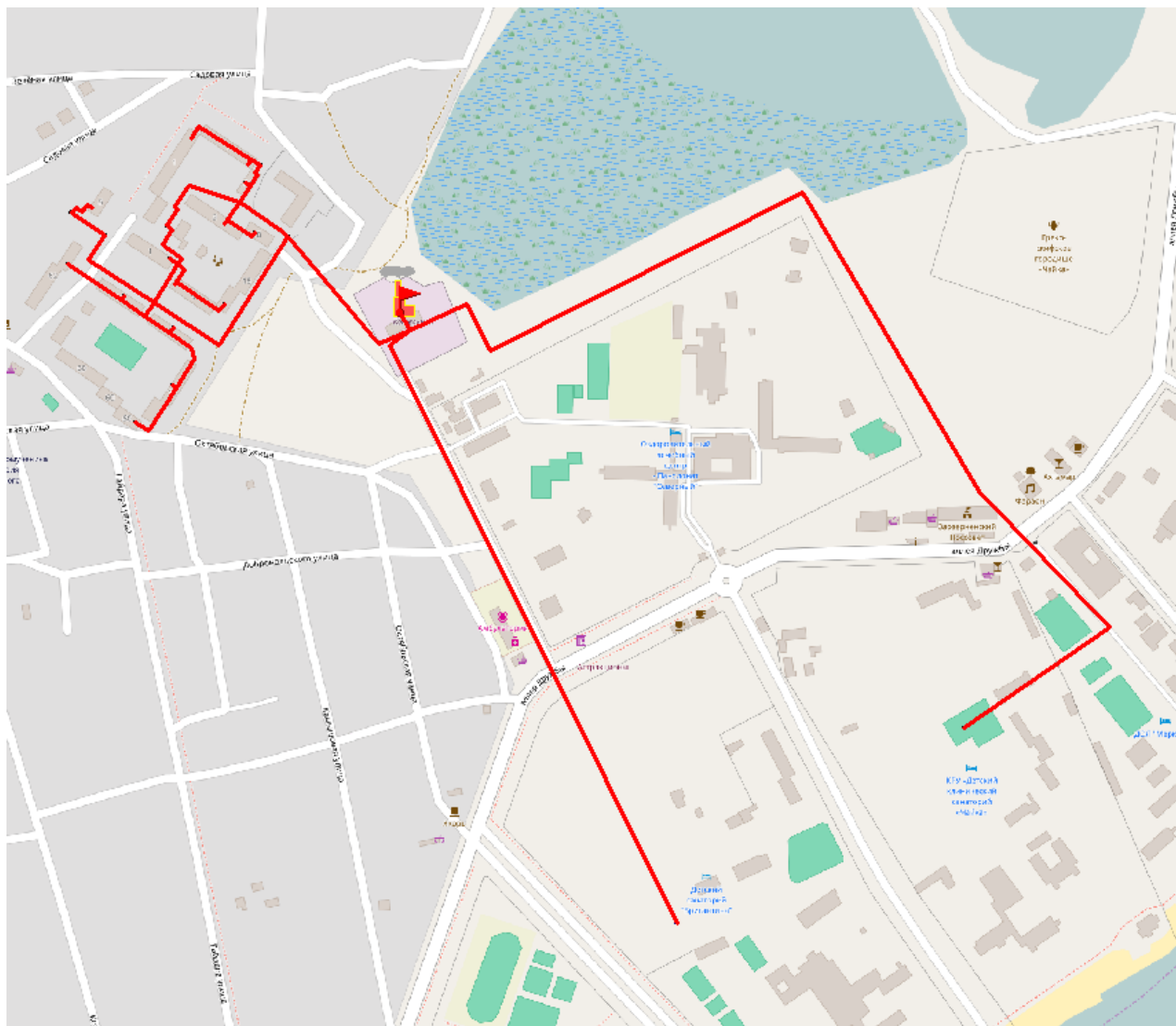
Рисунок 27 – Схема и структура тепломагистралей котельной по ул. Аллея Дружбы, 66-б
