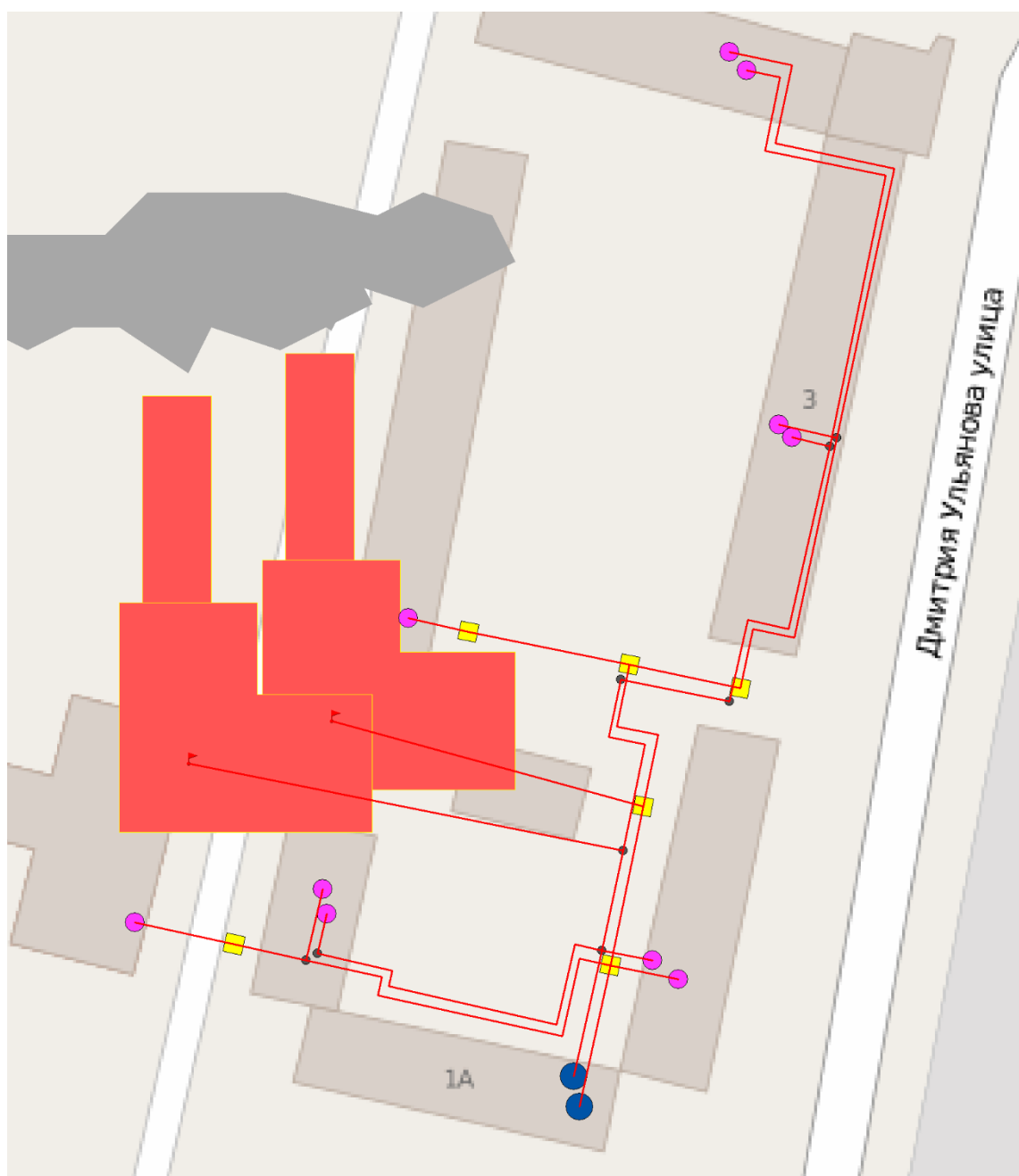
Рисунок 17 – Схема и структура тепломагистралей котельной по ул. Ульянова, 16
